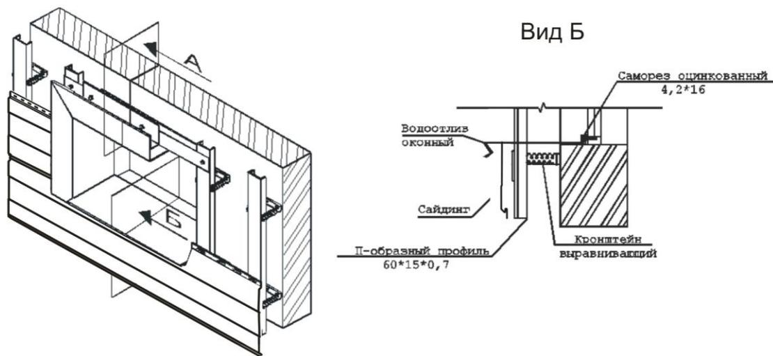
Рис 5. Обрамление оконного проема планкой внешнего откоса.
