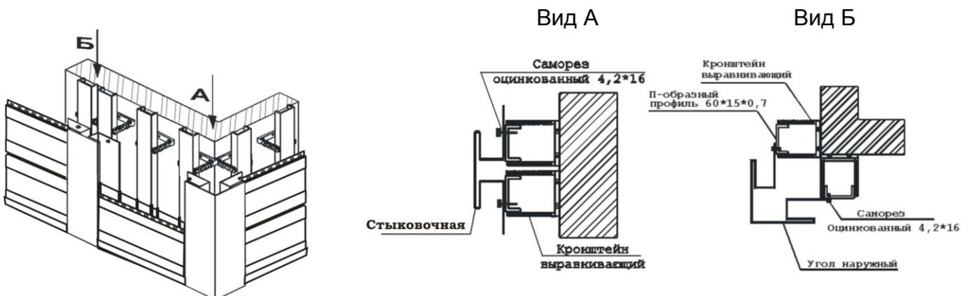
Рис 4. Установка углов и Н-образных планок.
