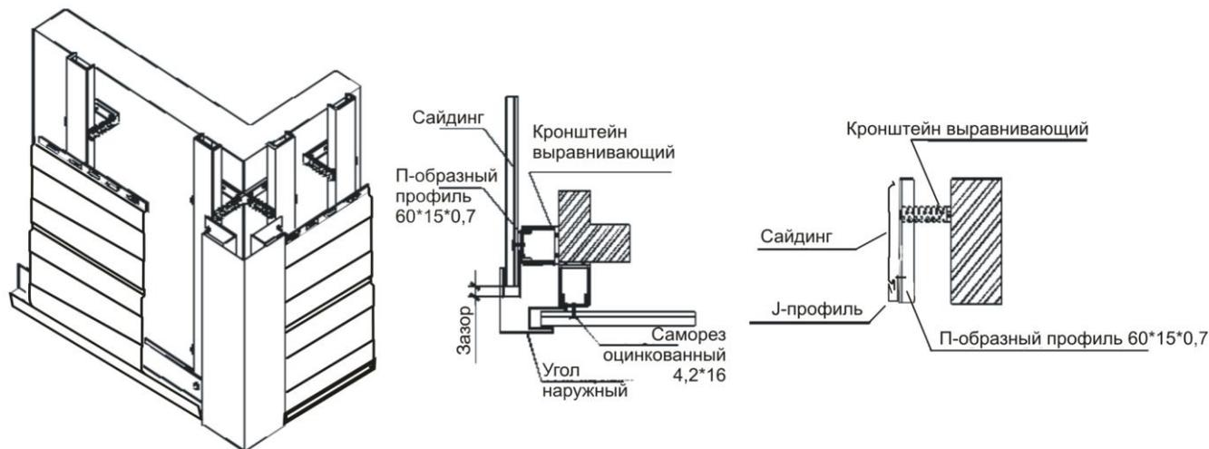
Рис. 7. Установка панелей
