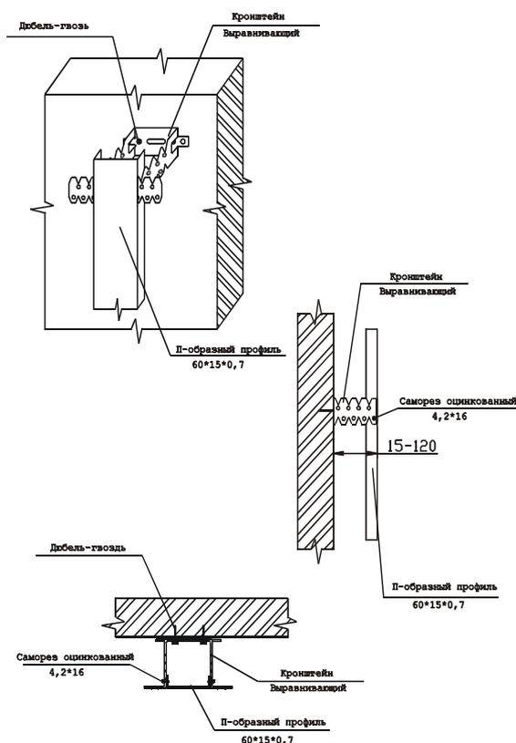
Рис. 2. Выравнивающая система
