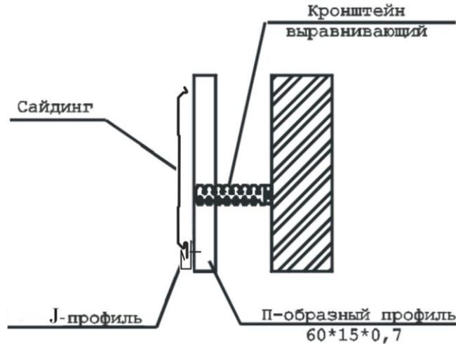
Рис. 3. Установка J-профиля при горизонтальном монтаже сайдинга.
